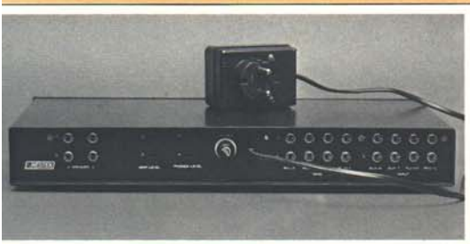
Über ein langes Kabel miteinander verbunden: V 2 und externes Netzteil
